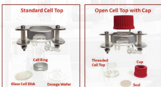
ภาพที่ 2 Vertical Diffusion Cells (Cell Tops) แบบ Standard Cell Top (ขาว) และ Open Cell Top with Cap (ซ้าย) โดย Standard Cell Top เหมาะกับตัวอย่าง ที่มีความหนืดสูง เช่น ครีม ขี้ผึ้ง เจล และ Open Cell Top with Cap เหมาะกับตัวอย่างที่มีความหนืดน้อย เช่น ยาน้ำ โลชั่น เป็นต้น
