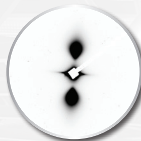
การกระเจิงรังสีเอกซ์มุมแคบ แสดงโครงสร้างลามেলাของพอลิเมอร์
