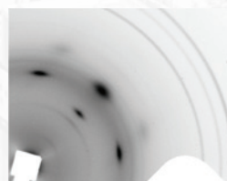
การกระเจิงรังสีเอกซ์มุมกว้างแสดงโครงสร้างผลึกของยางภายใต้แรงดึง
